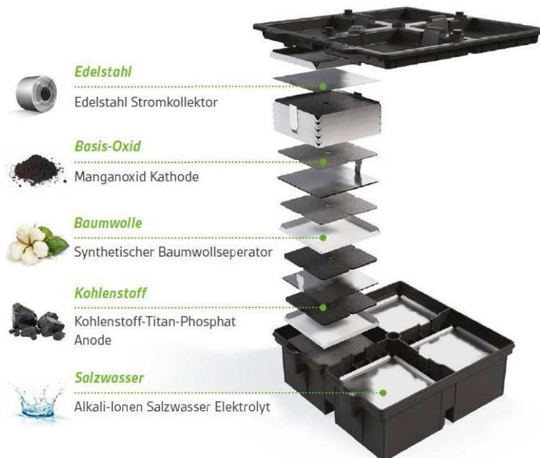
Entre el ánodo de carbono-titanio-fosfato y el cátodo de óxido de manganeso, los iones migran desde el electrolito de agua salada y hacen posible el flujo de energía. Al cambiar los iones entre el ánodo y el cátodo, la batería se carga y descarga. Solo se utilizan materiales con recursos suficientes, materias primas abundantes y no tóxicas.
